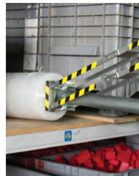
HW.2 Rura do pobierania szpul z ekstraktorem elektrycznym, ciężar ekstrakcji max 50 kg. Pipe to pick up reels with electric extractor, max extraction weight 50 kg.
